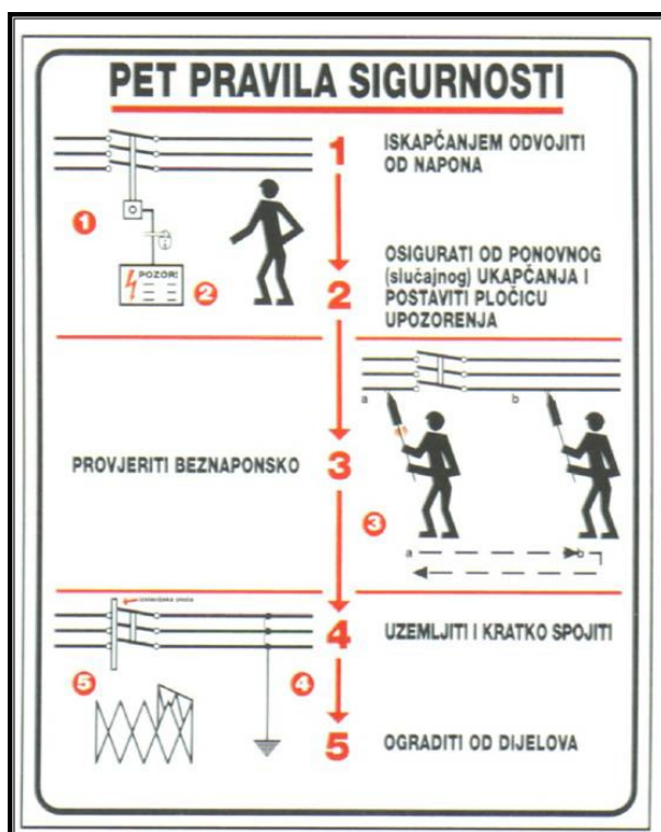
Slika 118: Pravila sigurnosti u elektroenergetskim postrojenjima
