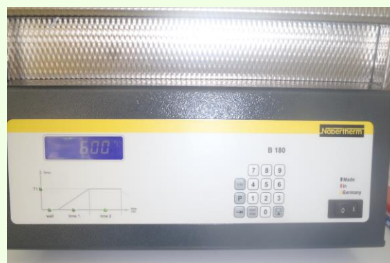
Slika 25. Spaljivanje u peći na 600°C
