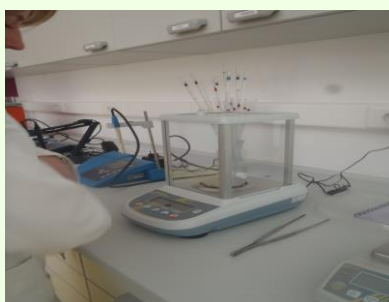
Slika 26. Analitička vaga s točnošću od 0,0002g
