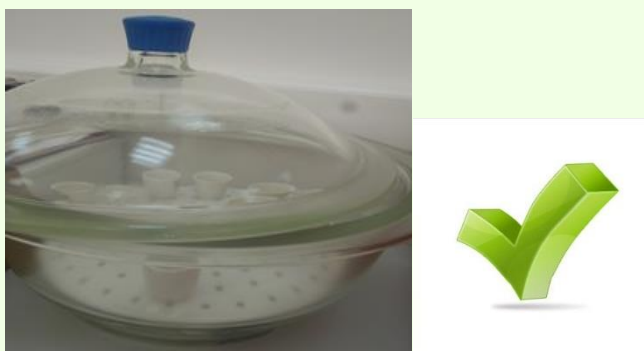
Slika 19. Eksikator (ne skroz zatvoriti)
