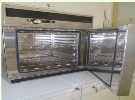
Slika 27. Sušionik s automatskom regulacijom temperature na 103°C
