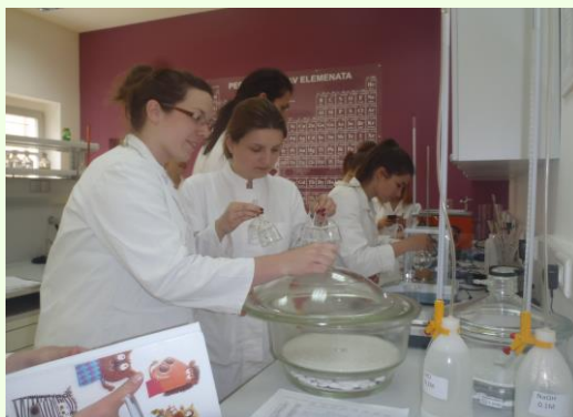
Slika 28. Postupak hlađenja u eksikatoru
