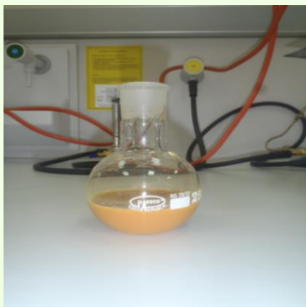
Slika 30. Boja nakon titracije s 0,1 mol/l otopinom natrijevotiosulfata
