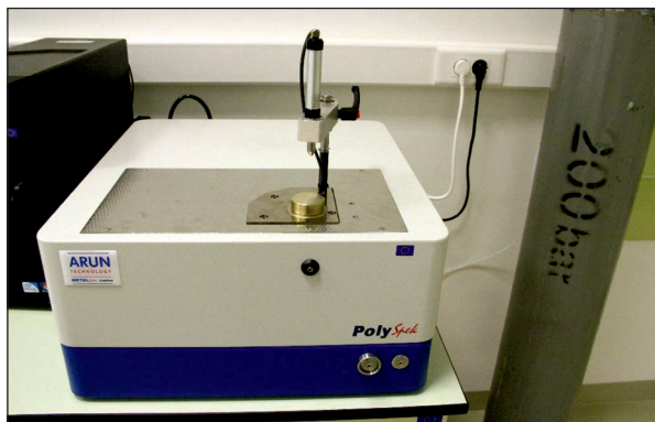
Slika 1.3: Spektroskop za analizu kemijskog sastava materijala [10]
