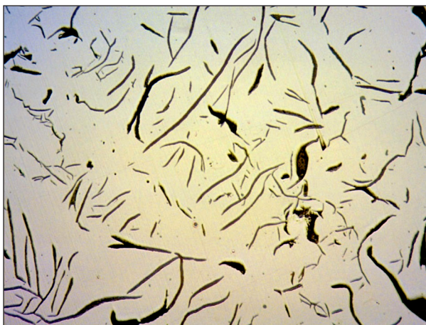
Slika 4.4: Mikrostruktura sivog lijeva SL 250 (polirano) [10]
