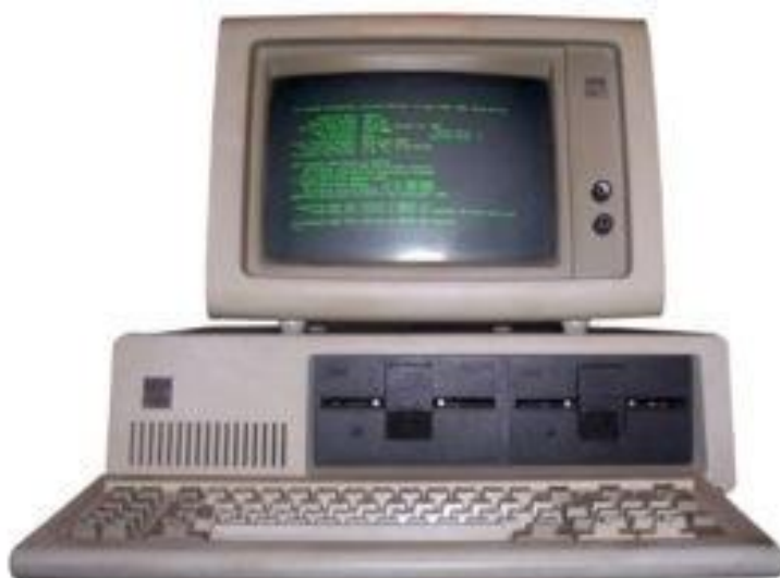
Slika 3.13. Prvi IBM PC Model 5150 iz 1981. g. (procesor Intel 8088 @ 4.77MHz)
