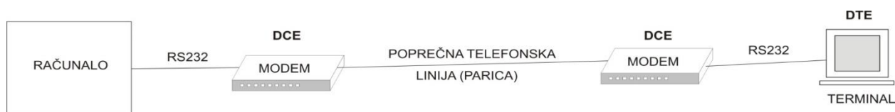
Slika 3.3. Načelna shema spajanja terminala na računalo putem modemske veze
