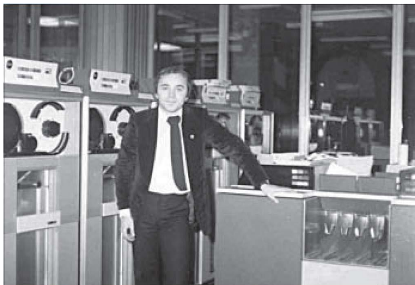
Jedinice magnetnih vrpca IBM 2401 čitač/bušač papirnih kartica IBM 2540 (fotografija iz 1975.)
