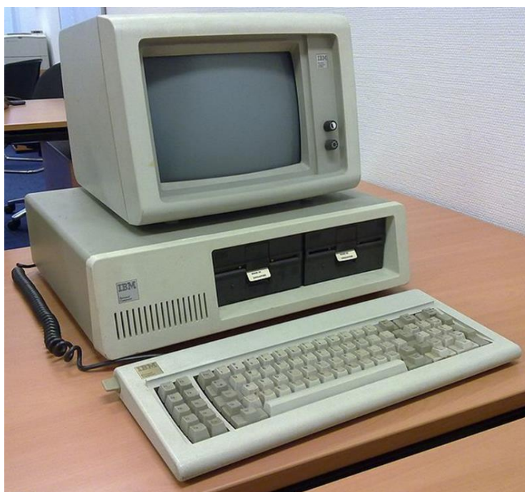
Slika 6.1. IBM PC 5150, 1981., procesor Intel 8088 @ 4.77MHz
