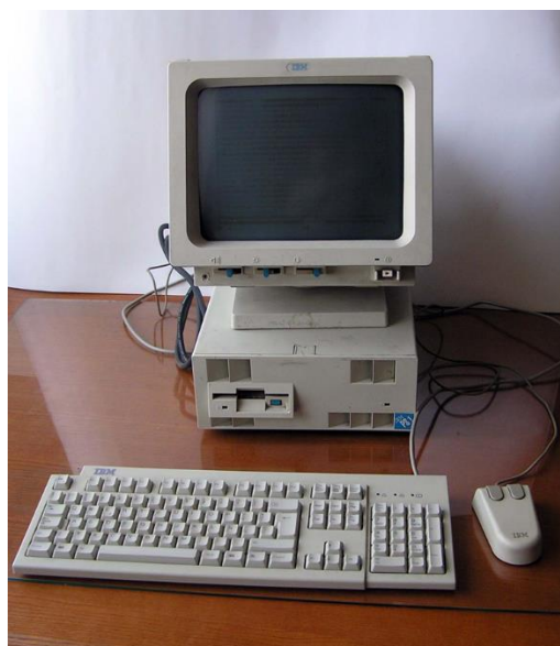
Slika 6.4. IBM PS/1, specifično „baby-AT” kućište, napajanje se nalazi u monitoru, 1993.g.
