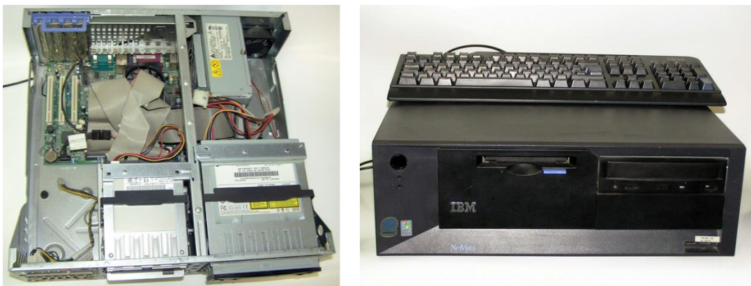
Slika 6.6. IBM NetVista A21, vodoravno ATX kućište iz 2002.g.
