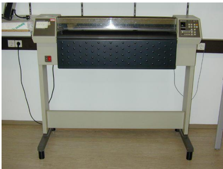
Slika 6.36. Ploter s valjkom HP Plotter 7585B
