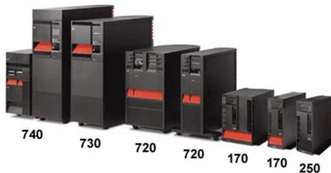
Slika 5.10. Primjer skalabilnosti IBM i-serije poslužitelja koja je nasljednica serije AS/400 – različite konfiguracije za različite namjene
