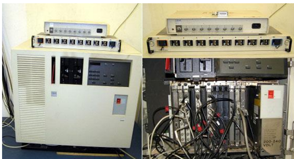
Slika 3.11. Udaljena kontrolna jedinica IBM 3174-11R – osnova SNA/3270 umrežavanja
