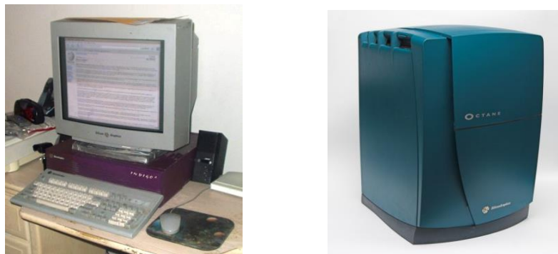
Slika 5.11. Grafičke radne stanice SGI Iris Indigo2 MIPS-R10000 (lijevo) i SGI Octane MIPS-R12000 (desno)
