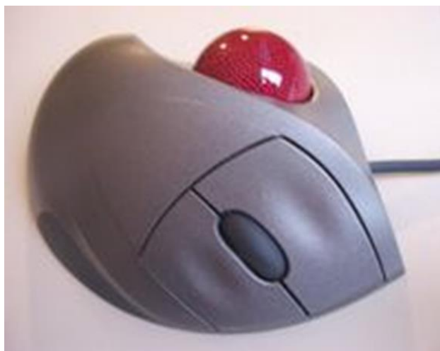
Slika 6.31. Logitech Trackman kugla ( trackball ) predviđen za upravljanje desnim palcem
