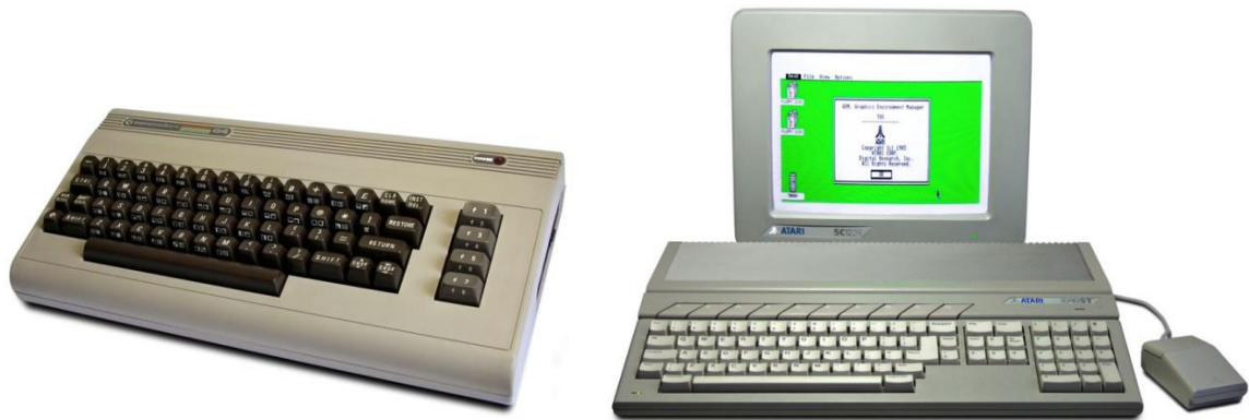
Slika 3.16. Mikroračunala Commodore64 (lijevo) i Atari 1040STf (desno)
