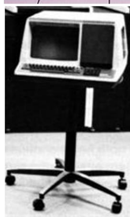
Slika 3.6. Detalj sustavske sale DEC VAX sustava (gore lijevo), središnje računalo (gore desno), te početak serije DEC terminala VT-52 (dolje desno) i VT-100 (dolje lijevo).
