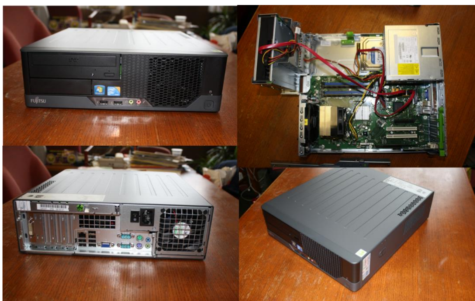
Slika 6.8. Fujitsu ESPRIMO E5731 E-Star5 sff (Intel Core2Duo, 3GHz, 6MB, 2GB DDR3 1333MHz) računalo iz 2011.g.
