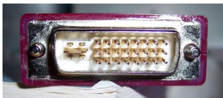
Slika 6.20. DVI konektor, muški na kabelu
