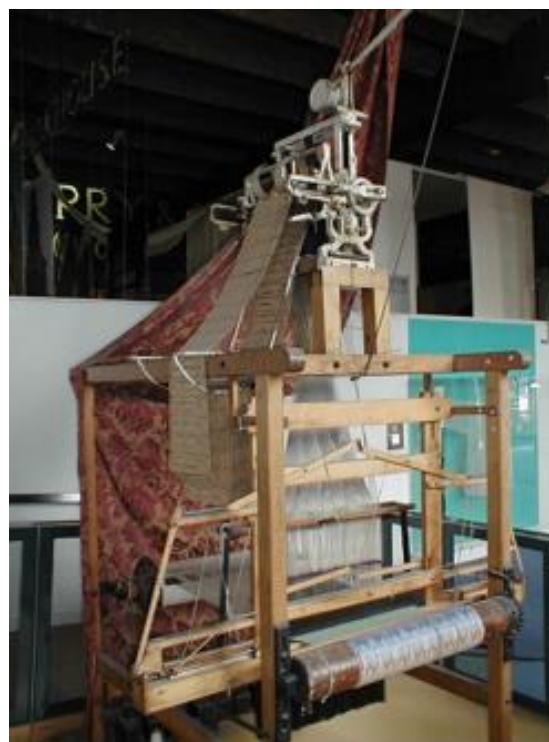
Slika 2.6. J. M. Jacquard i tkalački stroj s „programiranim” uzorkom
